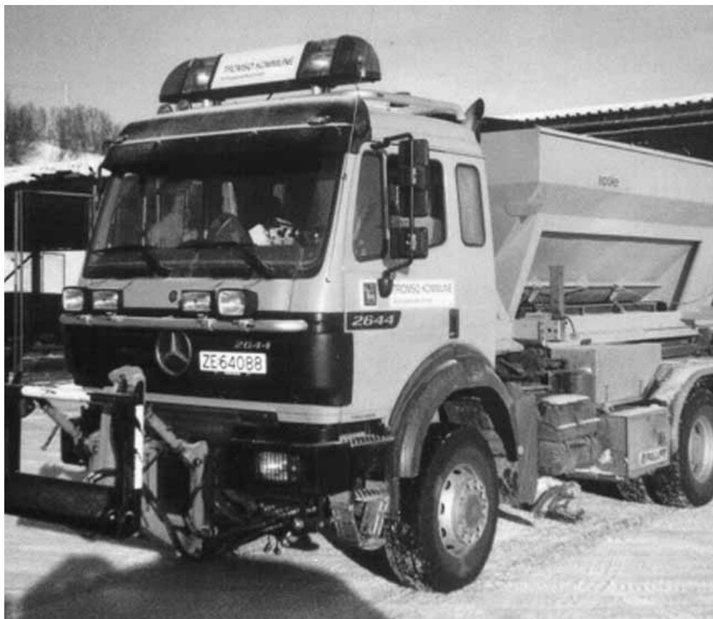
Flerbrukskjøretøy med brøytefeste, sandstrøer og høvelskjær.
