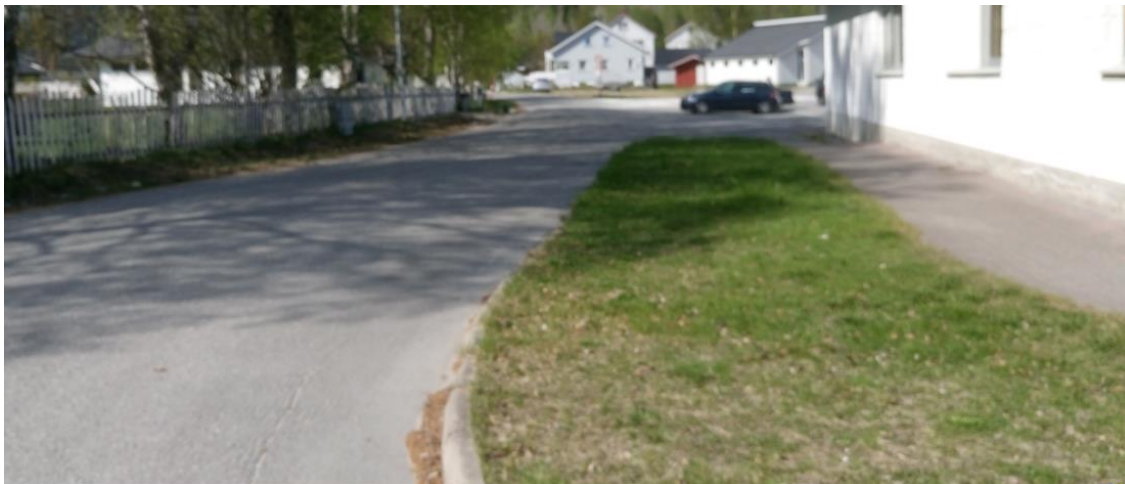
Med 3 meters fortau uten grøntrabatt vil en kunne flytte Parkgata ca 1 meter nordover inn mot krysset (foto Rambøll)
