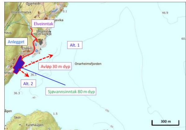
Figur 27 Oversikt over inntakspunkt for fersk- og sjøvatn, og utsleppspunkt for det planlagde postsmoltanlegget i området. Kjelde; Dokumentasjonsvedlegg til søknad om nytt landbasert anlegg for produksjon av postsmolt for Onarheim Bruk AS avd. Postsmolt på Onarheim i Tysnes kommune, Rådgivende biologer, 2018.
