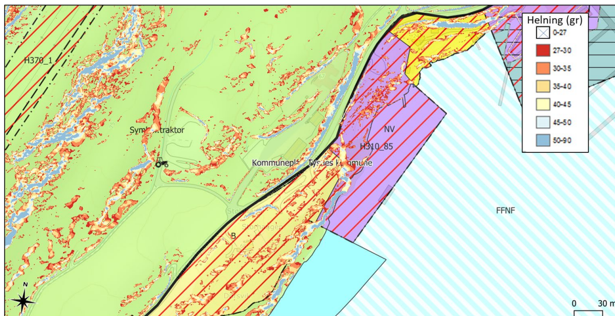
Figur 4 Reguleringskart (fra WMS, ikke oppdatert) med helningsdetaljer lagt over. Området med helningsdekke (27-90 gr) viser de aktuelle løseområdene for snøskred.
